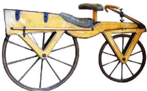
Дерев'яна дрезина конструкції Карла Драйза – перший двоколісний транспортний засіб
