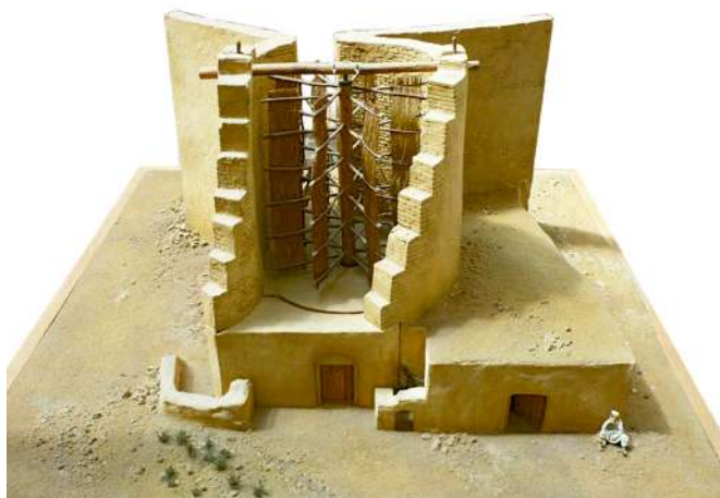
Схема і макет вітряка з вертикальною віссю IX ст. н. е., Східна Персія (сучасний Іран)
