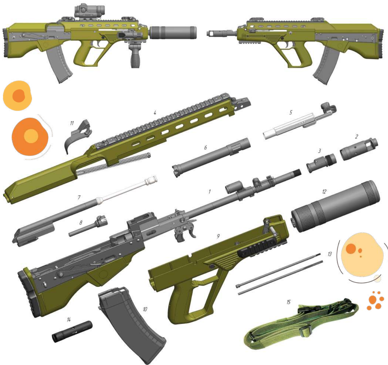
1 - ствол із ствольною коробкою, з ударно-спусковим механізмом і прикладом; 2 - дульне гальмо-компенсатор; 3 - дульна втулка; 4 - кришка ствольної коробки; 5 - газова трубка із рукояткою перезарядження; 6 - направляюча трубка; 7 - затворна рама з газовим поршнем; 8 - затвор; 9 - узел цев'я; 10 - магазин; 11 - гільзовідбивач; 12 - прилад ПЗРЗП; 13 - шомпол; 14 - пенал належності; 15 - ремінь.
