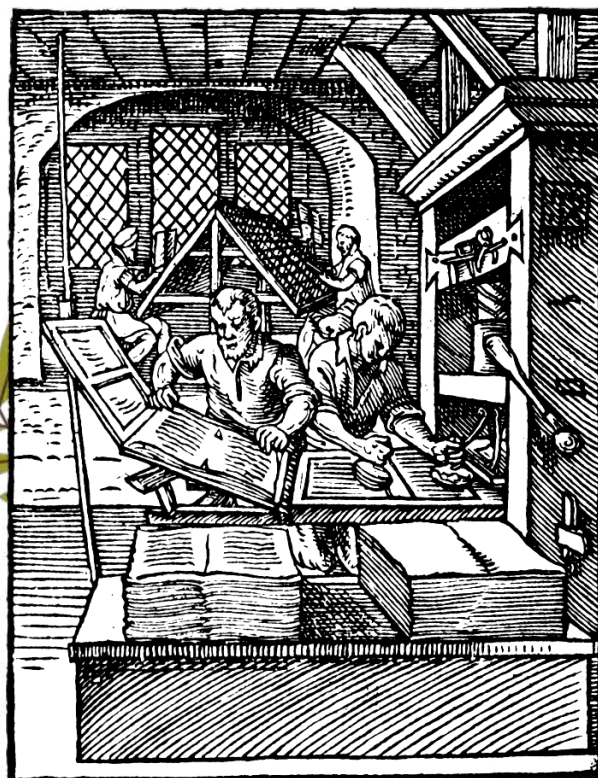
Гравюра на дереві 1568 року показує, що працівник зліва вилучає сторінку з пресу, а справа – друкує текстові блоки. Такий дуєт міг досягати 14 000 рухів руки за робочий день, друкуючи бл. 3600 сторінок у процесі
